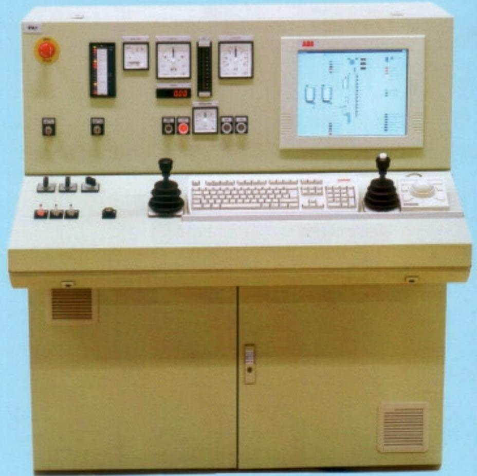
Распределенная микропроцессорная система управления шахтной подъемной машиной обеспечивает полную автоматизацию работы подъемной установки и максимальную безопасность. Система управления взаимодействует с микропроцессорной системой стволовой сигнализации и связи, обеспечивая управление исполнительными механизмами на горизонтах.
