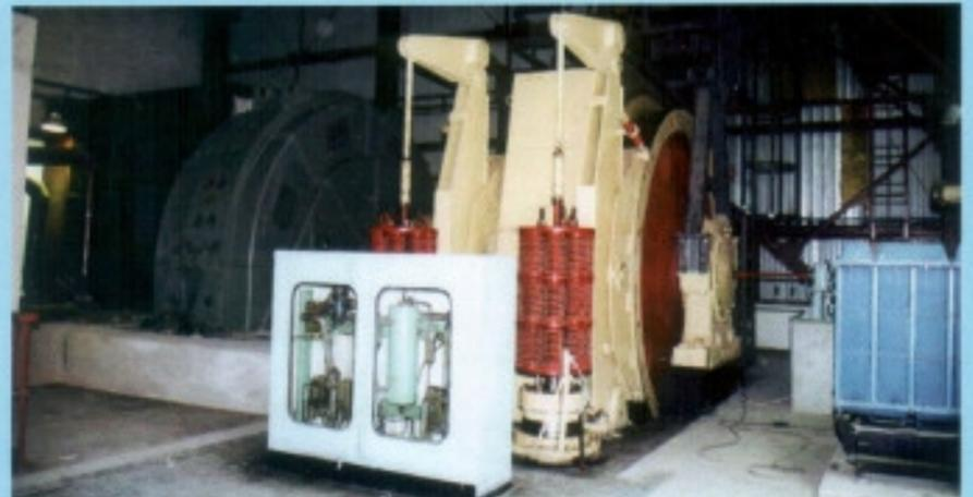
Оборудование подъемных машин ЦШ-4х4 и ЦШ-2,1х4 дисковыми тормозами, микропроцессорной системой управления и современным цифровым тиристорным приводом, Жаман-Айбат, республика Казахстан.
