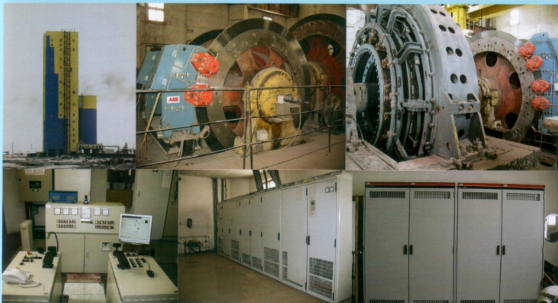
Оснащение подъемной машины дисковым тормозом с сохранением действующей системы привода на базе асинхронных двигателей с фазным ротором и релейно- контактной системы управления. МПБ-6,3х2,4х2,4Д Артемьевский рудник, корпорации «КАЗАХМЫС», республика Казахстан
