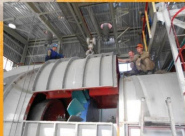
Вентиляторы типа ВО производства ООО «МИДИЭЛ» могут обеспечить подачу воздуха в пределах 30...1670 м<sup>3</sup>/с при давлении (депрессии) 60...1000 даПа, перекрывая рабочие области всех ранее выпущенных в СНГ осевых и центробежных вентиляторов.
